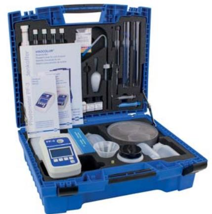
Kompaktphotometer PF-3 Soil, im Karton, inkl. Gebrauchsanleitung, Batterien und Zertifikat; zur Nachrüstung des VISOCOLOR® Bodenkoffers
