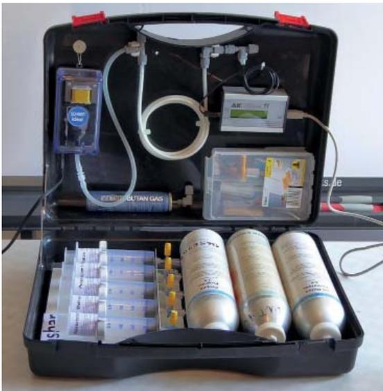
AK-GC KM: Im Komplettmodul ist fast alles drin (Druckdosen, Software und Hydrofill sind NICHT im Lieferumfang enthalten!)
