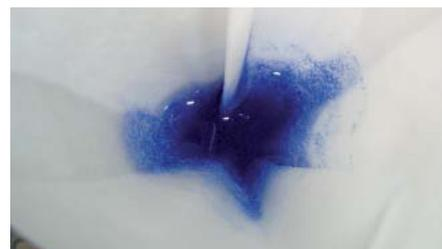
Die Abbildung zeigt an Polyamidpulver adsorbiertes Brillantschwarz
