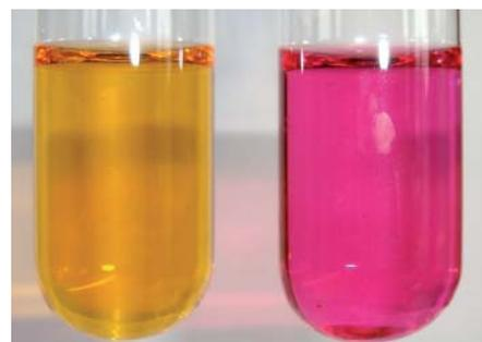
Die Abbildung zeigt die Lösung nach reduktiver Spaltung von Brillantschwarz mit Glucose (links, die Farbe der rechten Lösung wird nach dem Ansäuern erhalten)
