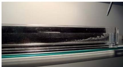
Der Kontakt der Zinkelektrode am Eisenstab führt zu einer wellenartigen Gasentwicklung von der Kontaktstelle weg.
