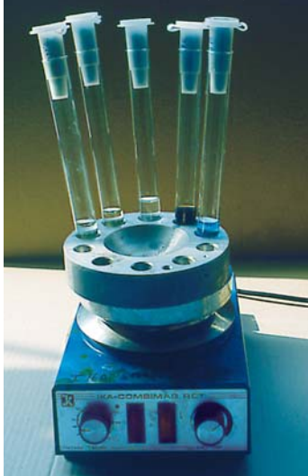
PM-Thermoblock mit Reagenzgläsern
