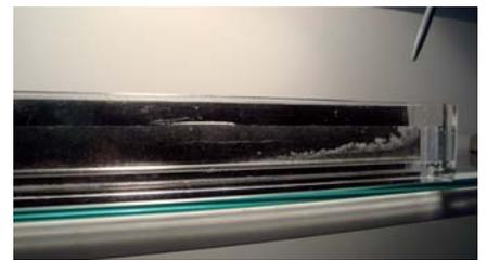
Der Kontakt der Zinkelektrode am Eisenstab führt zu einer wellenartigen Gasentwicklung von der Kontaktstelle weg.
