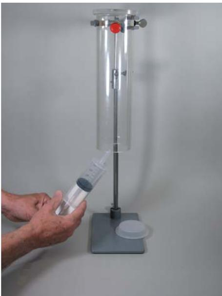
Einfüllen von Wasserstoff (leichter als Luft)
