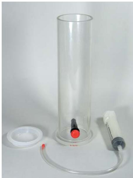
Zündrohr mit 50 ml-Spritze und Schlauch für Feuerzeuggas-Abfüllung
