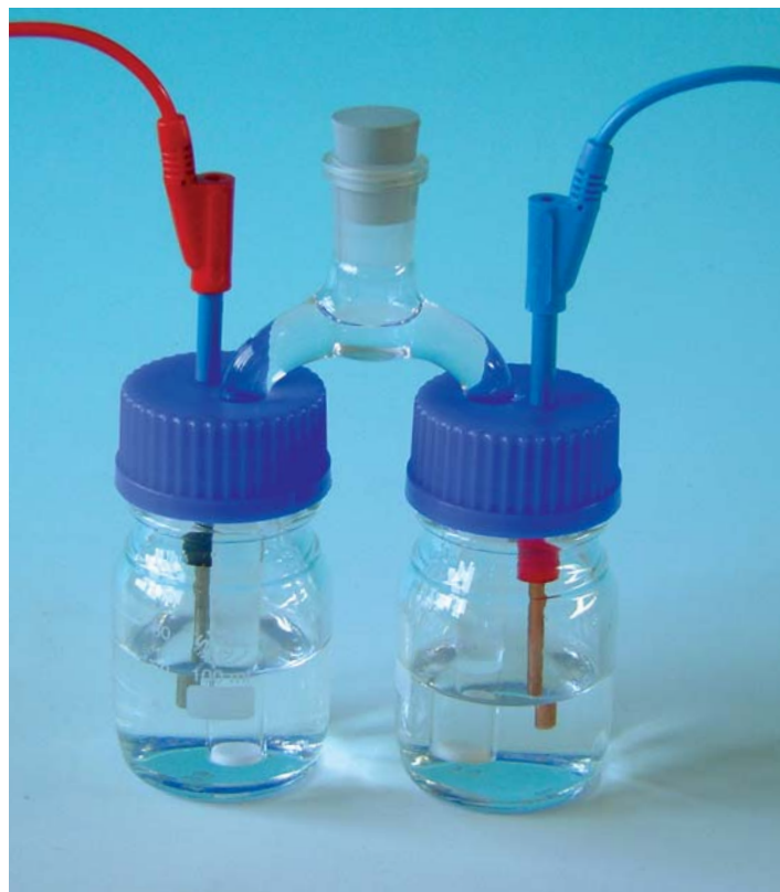
Die Messflaschen werden mit einem Stromschlüssel verbunden
