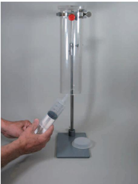
Einfüllen von Wasserstoff (leichter als Luft)
