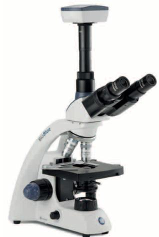
CMOS-Mikroskopkamera auf Mikroskop
