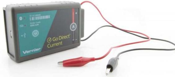
Der Go Direct Stromstärkesensor wurde für das Erforschen der Grundprinzipien der Elektrizität entwickelt. Verwenden Sie den Go Direct Stromstärkesensor zur Messung von Strömen in Niederspannungs AC/DC-Stromkreisen. Mit einem Messbereich von  $\pm 1$  A ist dieser Sensor ideal für den Einsatz in den meisten "Batterie und Glühlampe" Stromkreisen.
